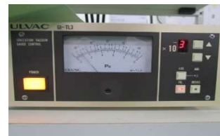
成膜時到達圧力 1.1 \times 10^{-3} DP起動後約3時間
